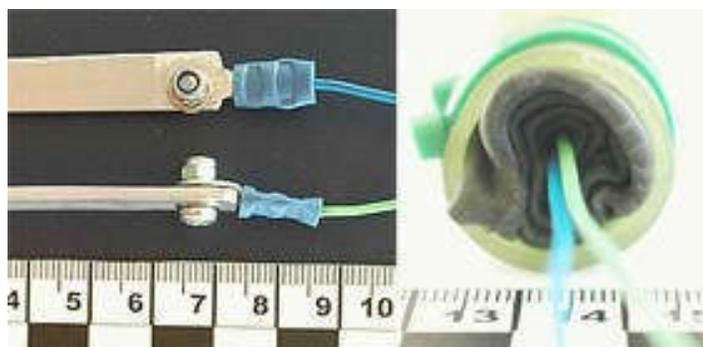
Chacun des bouts est soigneusement isolé, puis on les réunit deux à deux aux extrémités. les deux tiges se retrouvent alors l'une au-dessus de l'autre, avec un espace entre elles.
