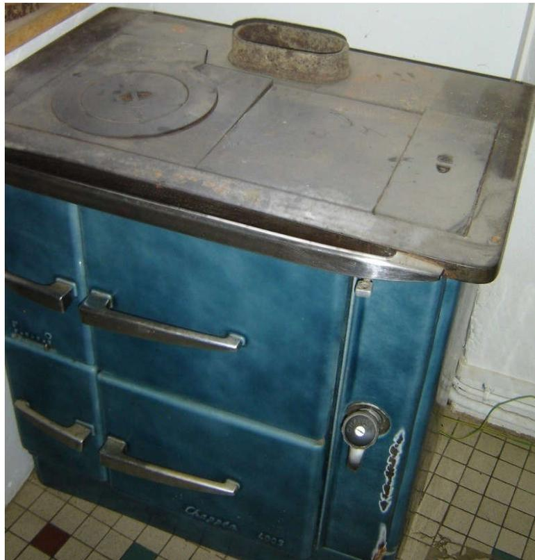
Figure 12. Une cuisinière Chappée. A droite de la plaque de cuisson, le compartiment pour l'eau, et au-dessous le robinet.
